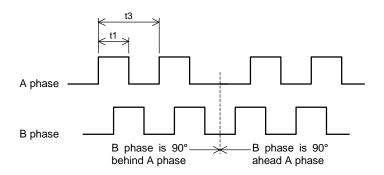
Fig. 5.25 A & B Phase Inputs
