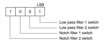
Fig. 7.10 Filter Switch
