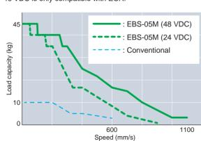
Max. load capacity: 10kg ⇒ 45kg (horizontal) Max. speed: 600mm/s ⇒ 1100mm/s (horizontal) \*Comparison with ☐ 42 size
