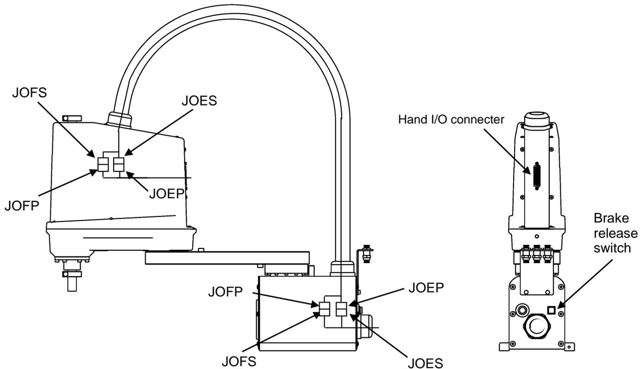
Fig. 11.3 Tool wiring (KHL-300 and KHL-400)
