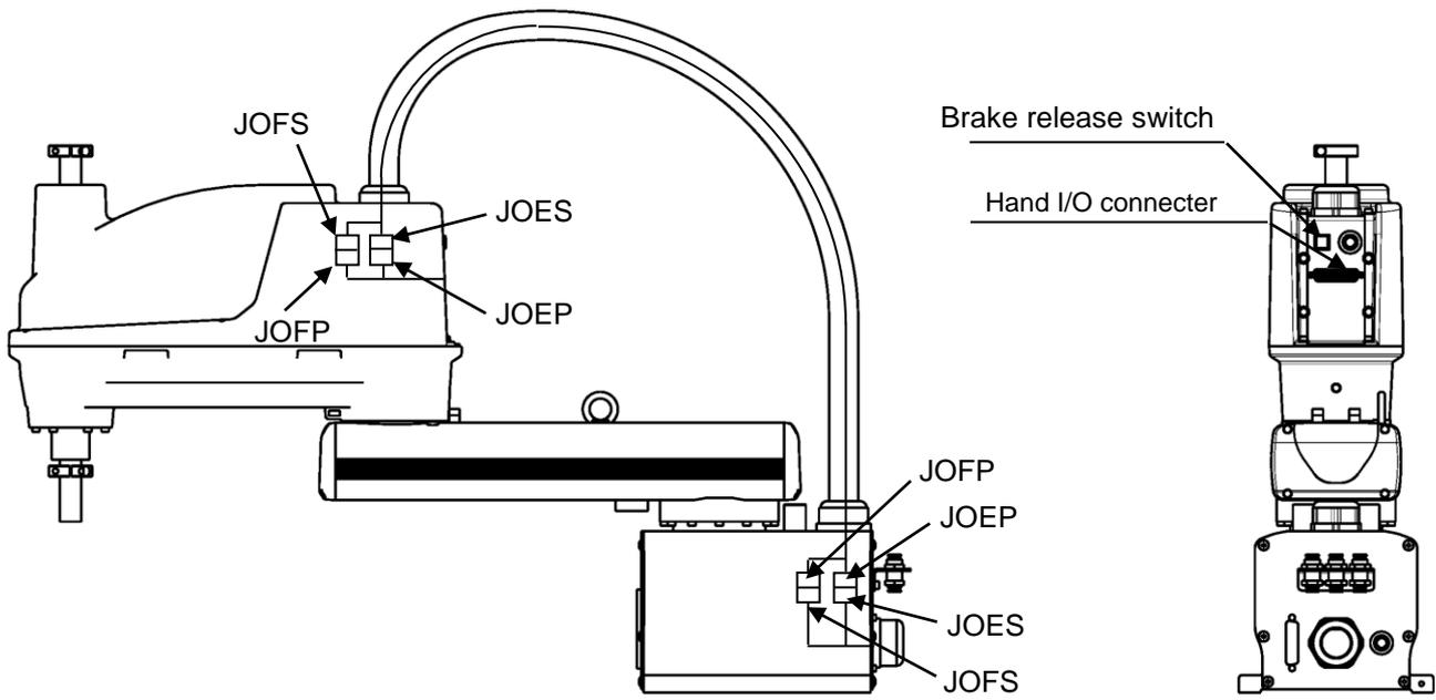
Fig. 11.4 Tool wiring (KHL-500, KHL-600 and KHL-700)
