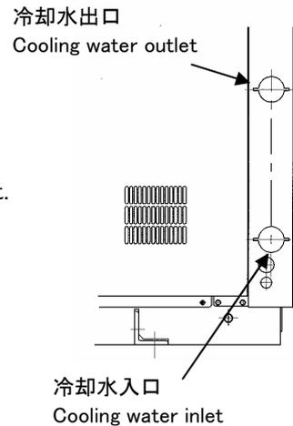
2) 冷却水の入口、出口間に“バイパスバルブ（バイパス回路）”、冷却水の入口、出口側に“空気抜き兼ドレンバルブ”を必ず取り付けてください。寒冷期、冷却水の凍結のおそれのある場合などに冷却水の連続循環や本機内の水抜きが必要となります。
