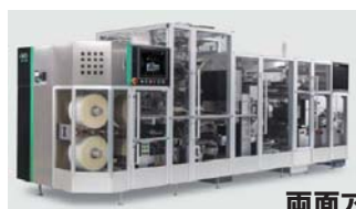
両面アルミ包装 中速機 生産能力:3000錠/分
