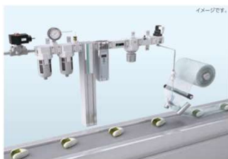
窒素ガス精製ユニット
