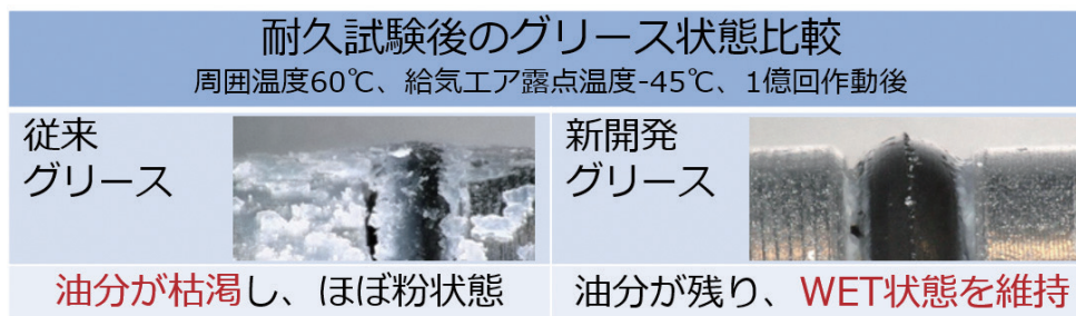
Fig. 6 耐久試験後のグリースの比較
