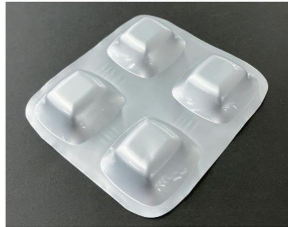
Fig. 9 AL成形写真(深さ19mm)
