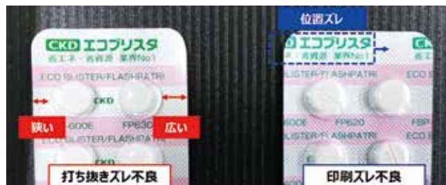
Fig. 2 打ち抜きズレ・印刷ズレ不良
