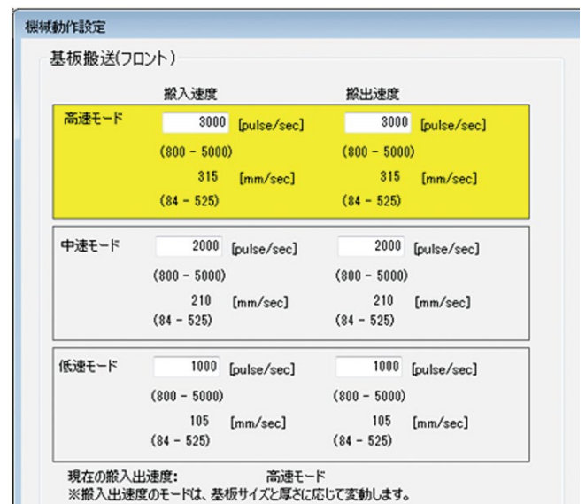
Fig. 10 基板搬送速度設定画面
