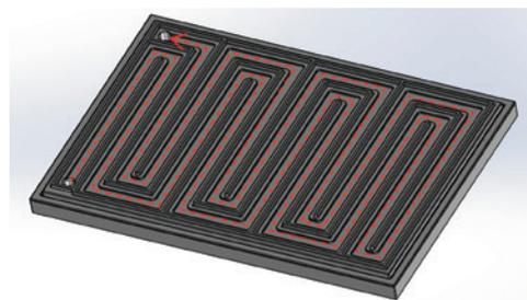
Fig. 5 培養液流路
