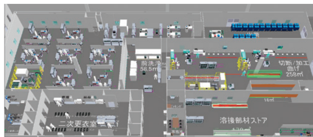
Fig. 9 製作した仮想3D工場
