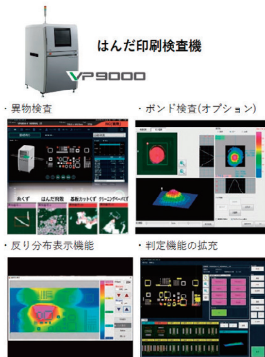
Fig. 1 はんだ印刷検査機の検査画面
