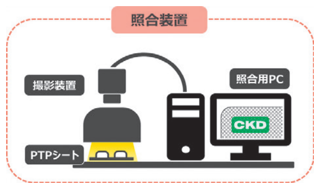
Fig. 6 照合装置 構想図
