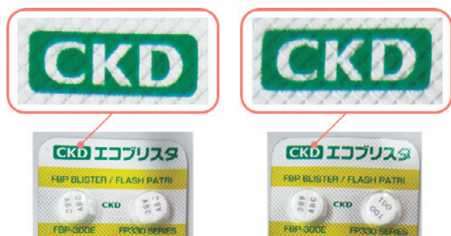
Fig. 5 PTPシートの物体指紋の一例
