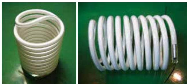
Fig. 12 CCFLスパイラル成形サンプル
