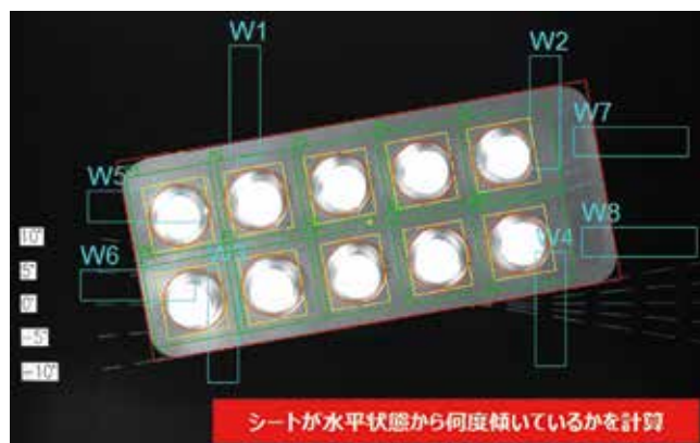
Fig. 9 シート4辺の抽出と傾き計算
