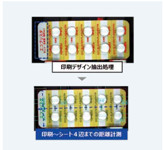
Fig. 11 印刷デザインの抽出と距離計測
