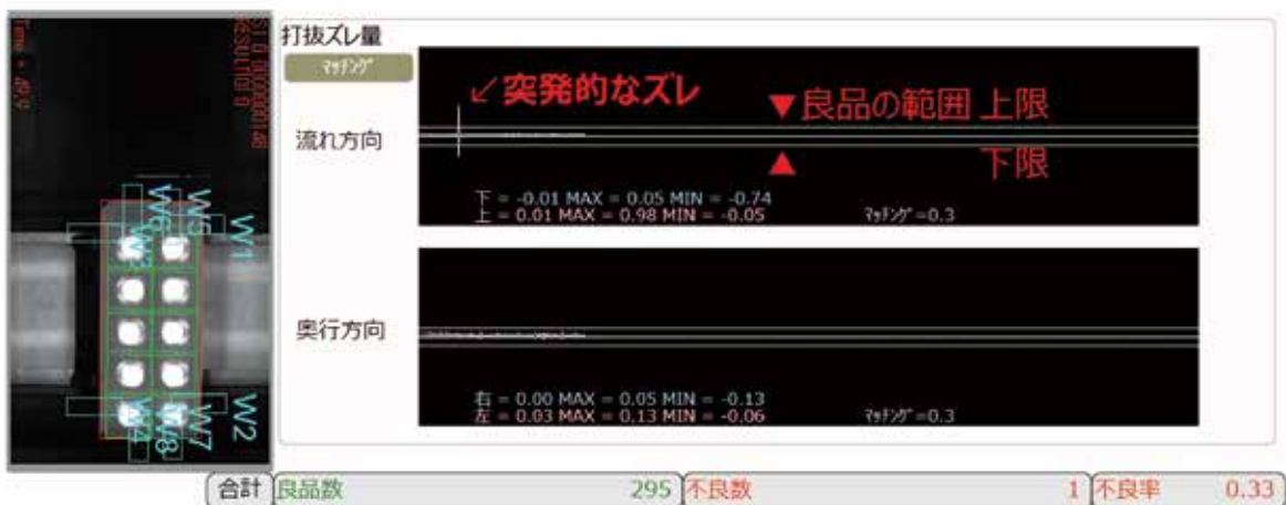
Fig. 12 打ち抜きズレ量のグラフ表示
