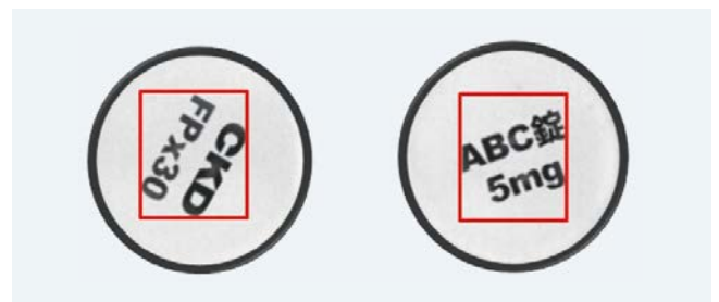
Fig. 6 従来の表裏で印刷の異なる錠剤の検査
