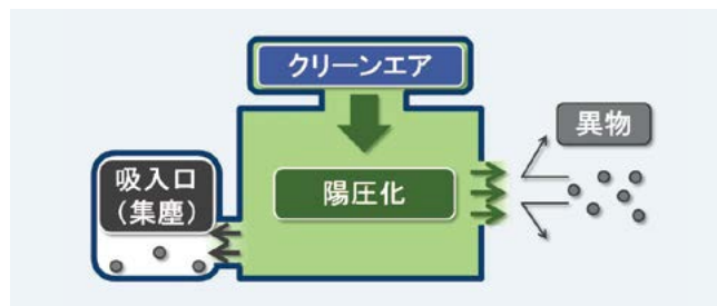
Fig. 6 機械内部の陽圧化
