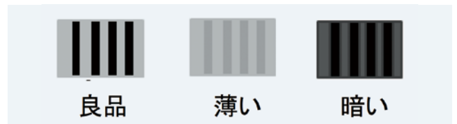
Fig.10 コントラスト検査
