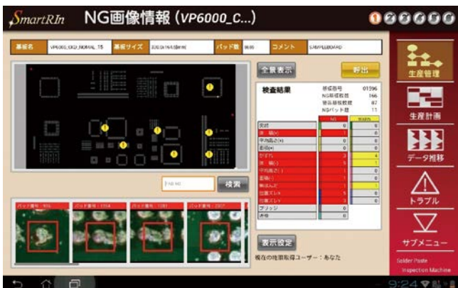
Fig.4 不良確認画面
