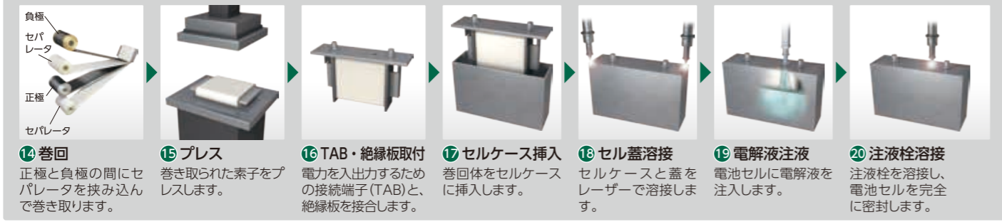
14 巻回 15 プレス 16 TAB・絶縁板取付 17 セルケース挿入 18 セル蓋溶接 19 電解液注液 20 注液栓溶接
