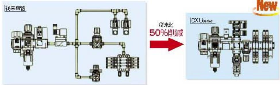
空気圧事業：超小型マニホールド電磁弁
