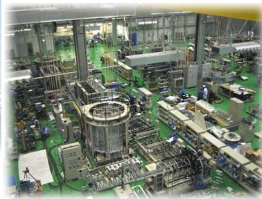
液晶用バックライト製造装置
