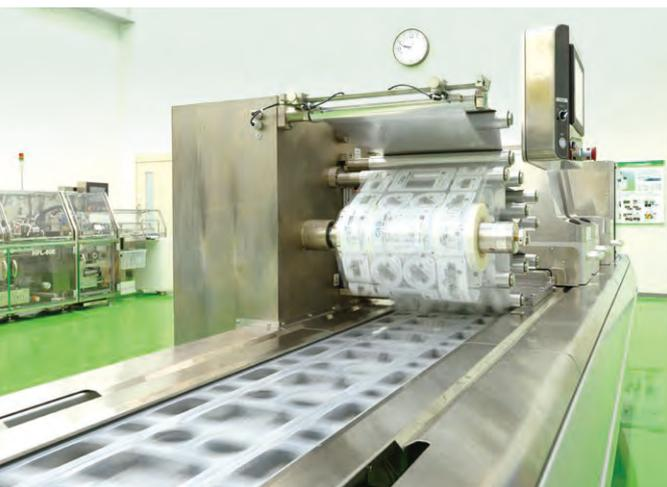
食品用包装機 エコプリスタCFF-360Eシリーズは、市場に求められている省人化、ランニングコストの削減、異物混入対策をコンセプトに、「安全・容易・デザイン・環境」を追求しました。特に環境性に優れ、医薬品を包装するPTP\*システムの技術を応用し、従来機種比で最大約51%の廃材フィルムと約30%の消費エアを削減しました。
