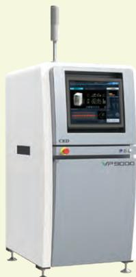
これまで構築してきた統計管理による品質維持・解析・改善機能の強化に加え、印刷パッドの微細化要求への対応と、検査速度の両立に向け、お客様が任意で分解能を切替えられる機能（マルチ分解能）を搭載しました。併せて、課題である欧米市場攻略を視野に入れ、視認性と操作性の改善を目的とし、タッチパネルディスプレイの大型化とGUIを刷新し、一層使いやすい検査機に進化しました。
