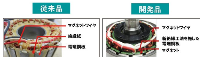
Fig. 7 新絶縁工法の巻線システム
