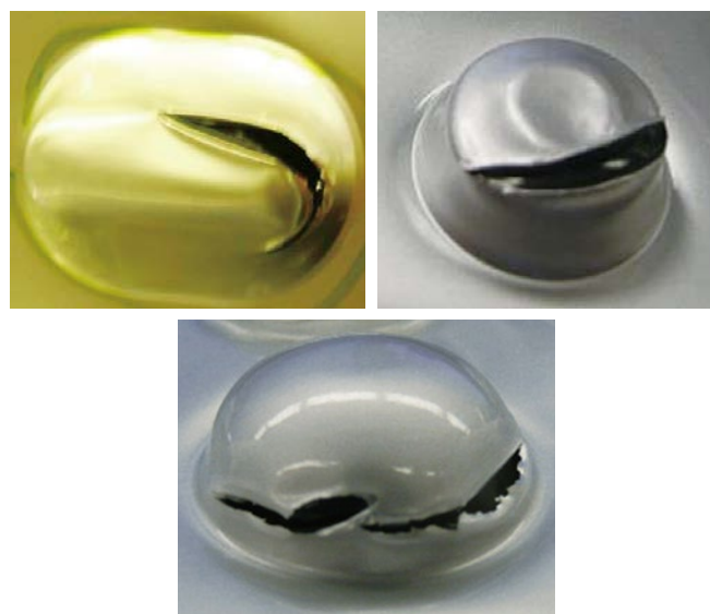
Fig. 17 ピンホール・クラック
