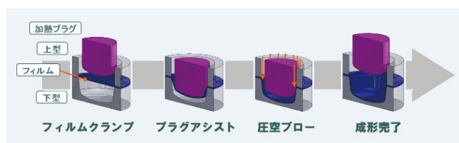
Fig. 4 プラグアシスト圧空成形
